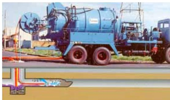
Sistema combinado de sewer jet e vácuo flex
