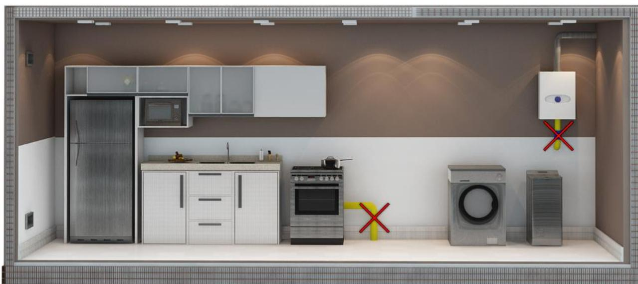
Figura 6.5 - Não é permitida a conexão direta do sistema de tubulação multicamada a aparelhos a gás
